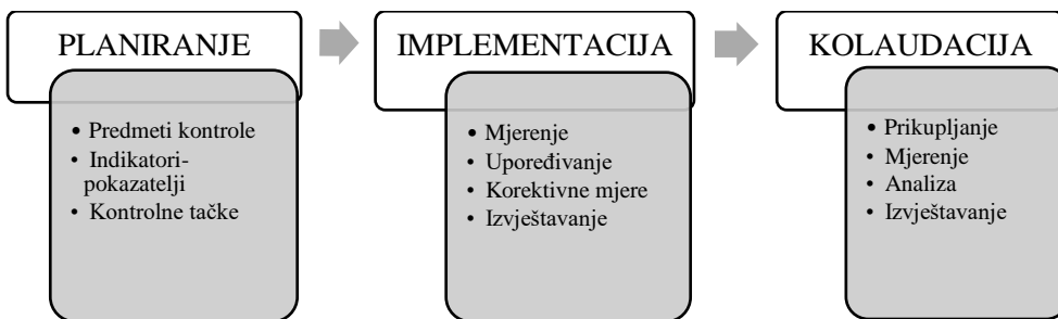
Slika 10-1. Proces kontrole u građevinskim preduzećima
