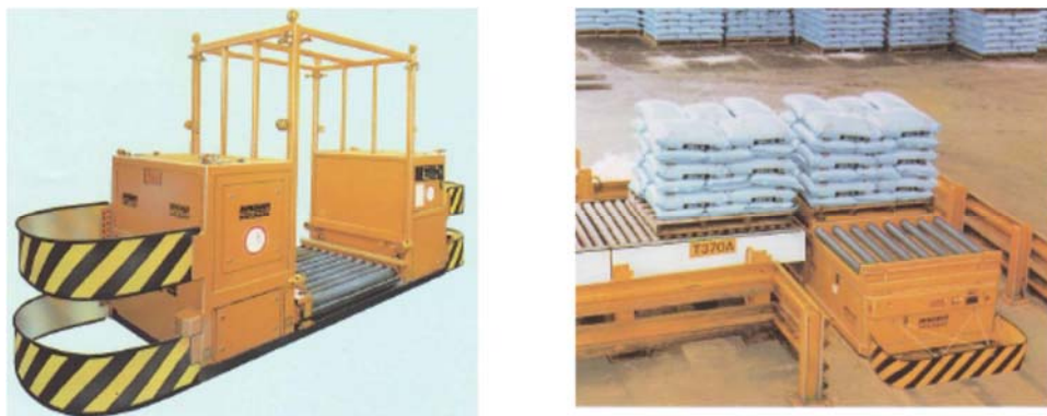
Slika 73. Paletna kolica sa automatskim zahvatanjem tereta [51]
