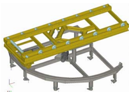
Slika 45. Varijanta sa obrtnim postoljem sa ugrađenim valjkastim transporterom [51]
