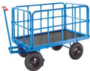
Slika 10. Ručna kolica sa rudom, obrtnom prednjom osovinom, kočnicom i nadgradnjom tovarnog prostora za obezbjeđenje tereta od ispadanja [26]
