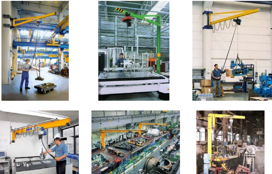
Slika 86. Primjeri upotrebe konzolnih dizalica i različiti načini postavljanja (na zid i na stub) [114, 115, 116, 117, 118, 119]
