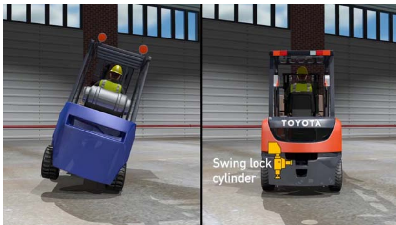
Slika 31. Primjer Toyota SAS sistema (System of Active Stability) [40]
