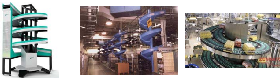
Slika 61. Spiralne kliznice i njihova primjena [73,74,75]
