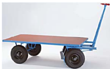
Slika 8. Jednostavna plato kolica sa rudom, obrtnom prednjom osovinom i kočnicom (kolica sa 4 točka) [24]
