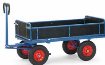
Slika 9. Ručna kolica sa rudom, obrtnom prednjom osovinom, kočnicom i nadgradnjom tovarnog prostora za obezbjeđenje tereta od ispadanja [25]
