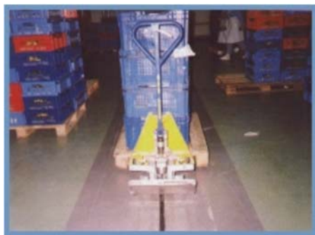
Slika 58. Varijanta sa vučnim organom ugrađenim u pod [51]
