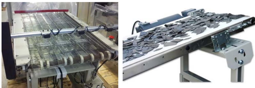
Slika 35. Primjeri trake izvedene od čelične mreže (lijevo) i magnetne trake (desno) [51]
