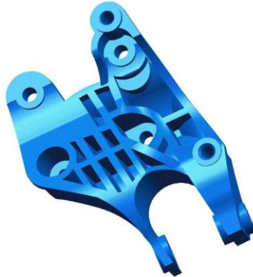
Slika 4. Drugo idejno rješenje nosača motora
