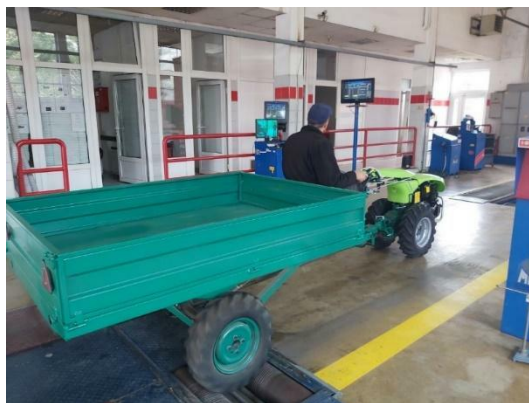
Slika 4. Ispitivanje kočionih cilindara i sila kočenja prikolice
